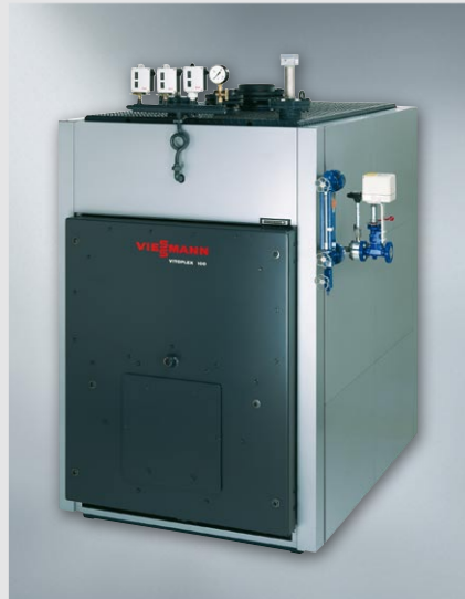
Vitoplex 100 – LS niskoprężny kocioł parowy o nadciśnieniu roboczym do 1 bar, 170 do 1450 kW
