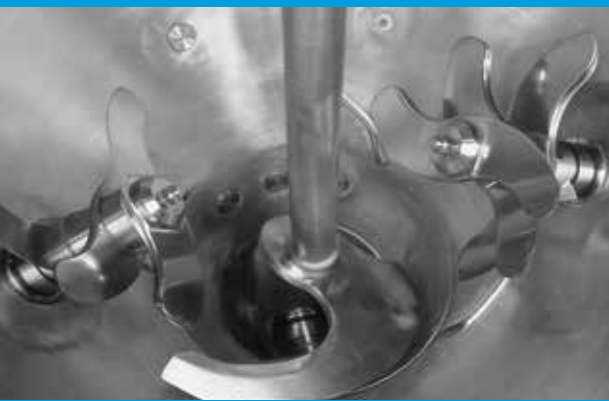
▼ Cuve de prébroyage Depósito de pre-picar
