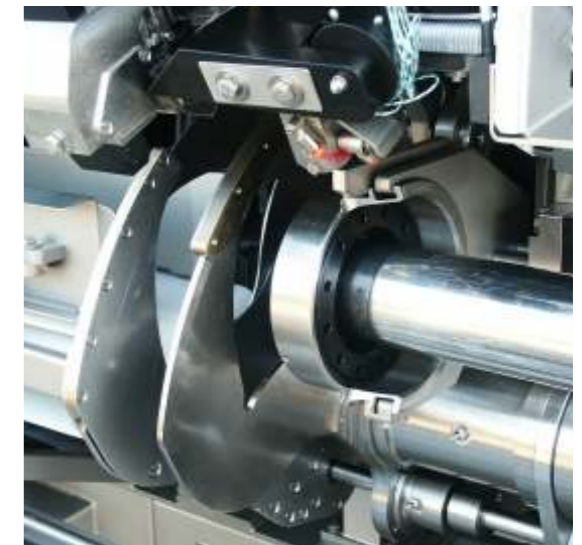
Verdrängerschere mit großem Durchlass Displacer with large passage Pincas de déplacement à grand passage Chapa de desplazamiento con gran pasada
