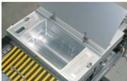
narzędzie formujące – górna część z podgrzewaniem wstępnym i unoszoną pokrywą do szybkiej wymiany elementów formujących (opcja)
