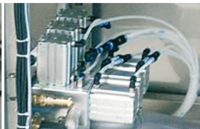
blok zaworów ze standardowymi siłownikami firmy Festo
