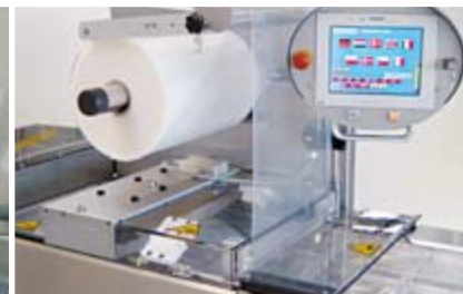
opatentowana stacja mocowania górnej folii (opcja), zalecana przy folii górnej z nadrukiem
